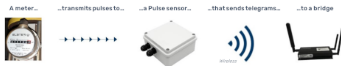
Grundlegende Funktionsweise des Impulssensors
