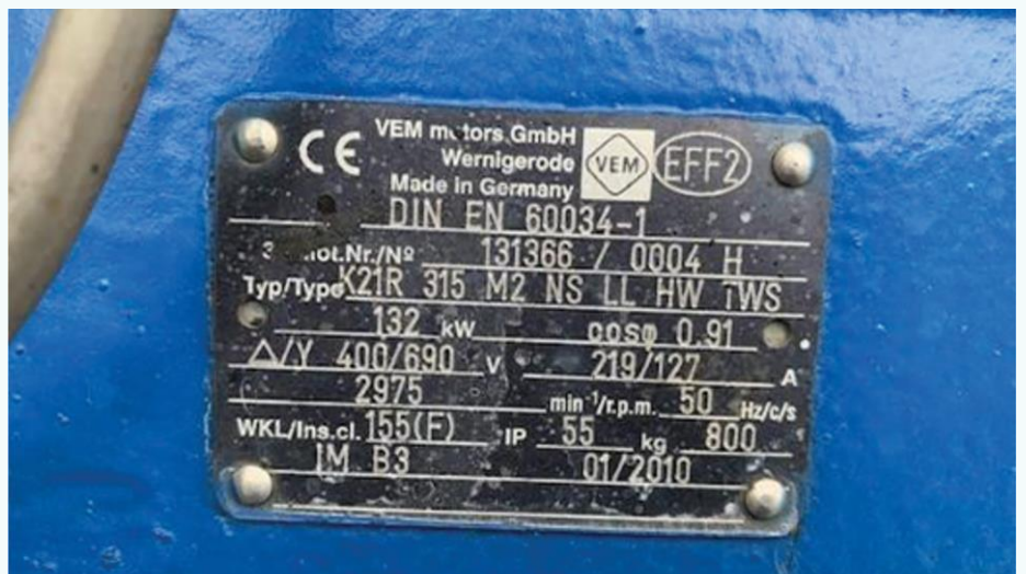
Typenschild des Motors (sofern vorhanden – scharf und lesbar)
